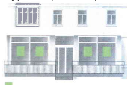
Места размещения информационных блоков в светопрозрачных конструкциях
